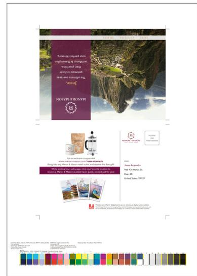
A inclusão de uma barra de controle nas páginas impressas ajuda a garantir o controle do processamento de cores.
