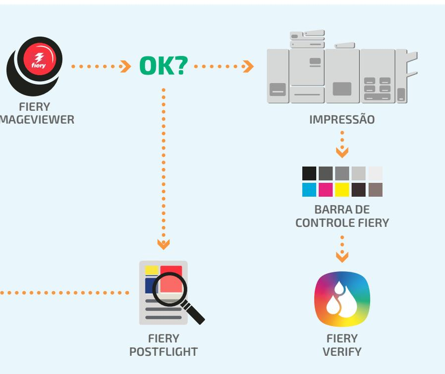
Use a **Barra de controle Fiery** para medir e monitorar as cores em todo o processo de impressão. Faça a medição das barra de cores com o **Fiery Verify** (incluído no **Fiery Color Profiler Suite**) para garantir o cumprimento de padrões como Fogra, ISO ou Idealliance.
